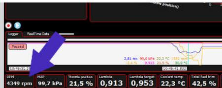
Démarrer, vérifier la polarité du capteur de régime, ajustez le point d'allumage initial avec une lampe stroboscopique.
