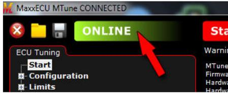
Après avoir installé le logiciel PC MTune, connectez le câble USB fourni et alimentez l'ECU. Pour commencer plus rapidement, rendez-vous sur [maxxecu.com/downloads](http://maxxecu.com/downloads) et téléchargez une cartographie de base appropriée. Chargez le fichier dans le MaxxECU en l'ouvrant (icône jaune à gauche) et en suivant les instructions à l'écran.
