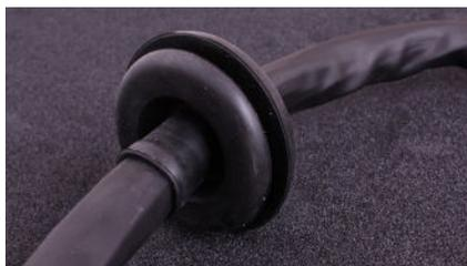
Utilisez un passe cloison pour ne pas abîmer le faisceau.
